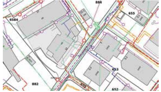
Das Leitungskatasterportal des Kantons Zürich bildet alle ober- und unterirdischen Leitungen für Wasser, Abwasser, Elektrizität, Fernwärme, Gas und Kommunikation ab. Das Tool steht seit Mai kostenlos zur Verfügung. BILD: WWW.ZH.CH
