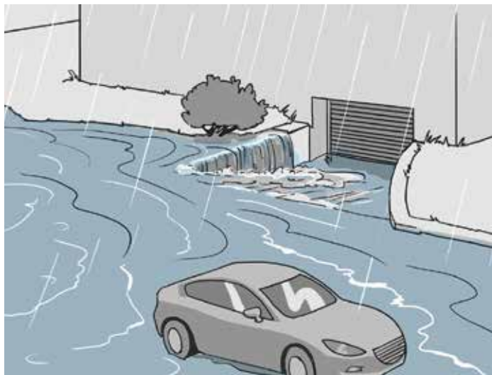
Lokale Starkregen bringen innert Minuten mehr Wasser, als die Entwässerungseinrichtungen zu fassen vermögen. Dieses fliesst oft von Strassen und Garagenzufahrten auf das Gebäude zu.
