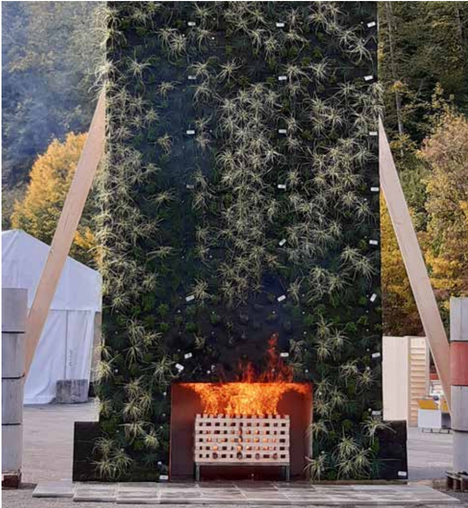
Grossbrandtest an einer begrünten Fassade: Nach rund drei Minuten beginnt das Strohfeuer zu lodern. BILD: BFH
