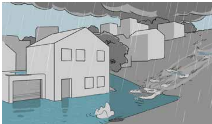
Abb. 1: Lokale Starkregen bringen innert Minuten mehr Wasser, als die Entwässerungseinrichtungen zu fassen vermögen.
