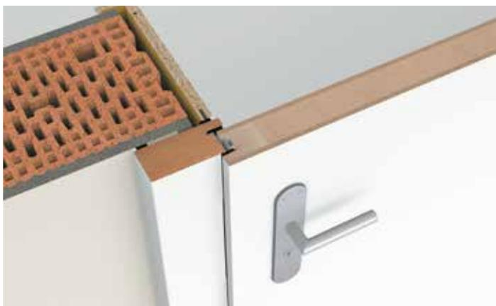
Bei bestehendem Holzfutter wird die Falzverkleidung entfernt und der Rahmen an die Holzzarge angeschlossen.
