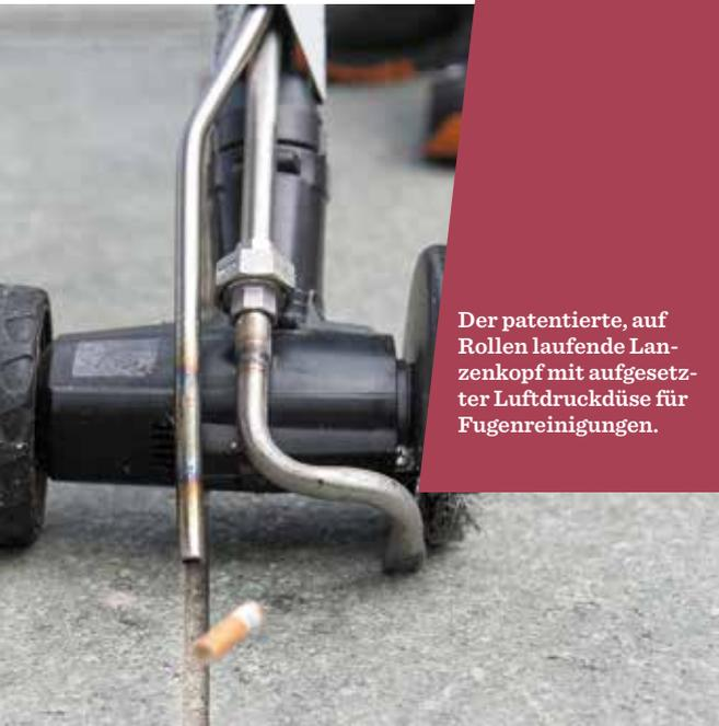
Der patentierte, auf Rollen laufende Lanzenkopf mit aufgesetzter Luftdruckdüse für Fugenreinigungen.
