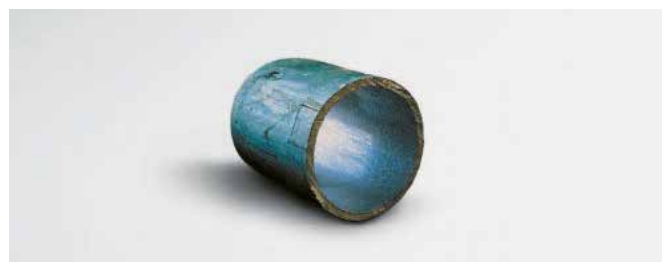
Innenseite eines durch Dipan mit Silikat behandelten Rohres
