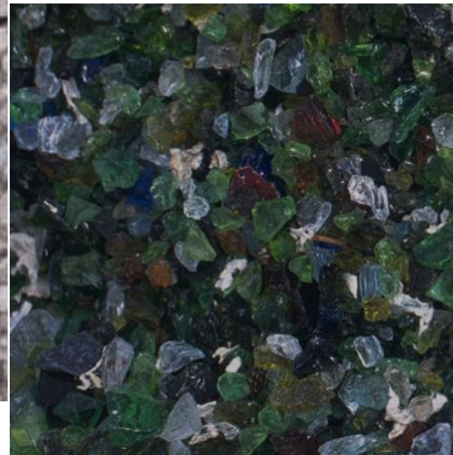
Verre concassé recyclé pour drainages
