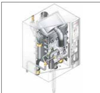
Das neue Gas-Brennwertgerät Thermo Condens WTC-GW 80/100-A im Schnitt.
