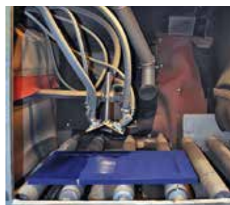
Mit Glasmehl werden zerstörte Pigmente und Schmutz abgestrahlt
